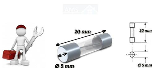
**Description** Fusible 5 x 20mm 6.3A • courant: 6.3A • 1.5 In: t>1H • 2.1 In: max. 30min. • 2.75 In: 50mS t
